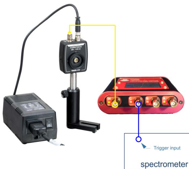
Fig. 37. Disparo de Espectrómetro a partir de la detección óptica de un pulso láser
