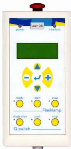
Fig. 30. Caja de Control del Láser Quantel, desde ella realizará la configuración de lámpara y Q-Sw para usar externamente el retardador
