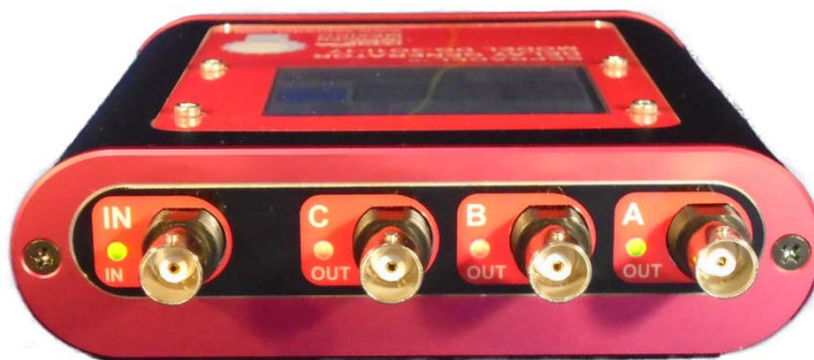
Fig. 1. Panel frontal del Generador de Retardos con entrada (IN) y salidas (OUT)
