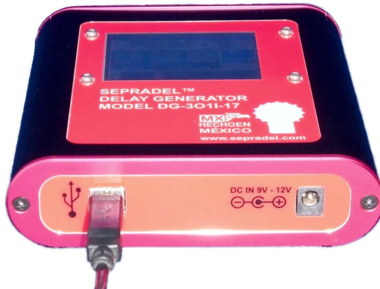
Fig. 2. Panel posterior del Generador de Retardos con puerto USB y entrada de Alimentación de 9VDC-12VDC, se muestra también el display táctil
